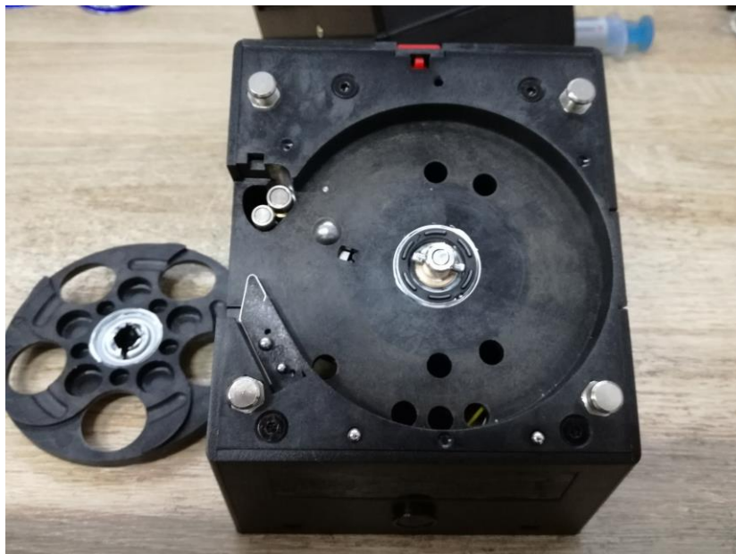
Rys. 1.8. Hopper z wyjętym dyskiem i blokadą wylotu monet.
