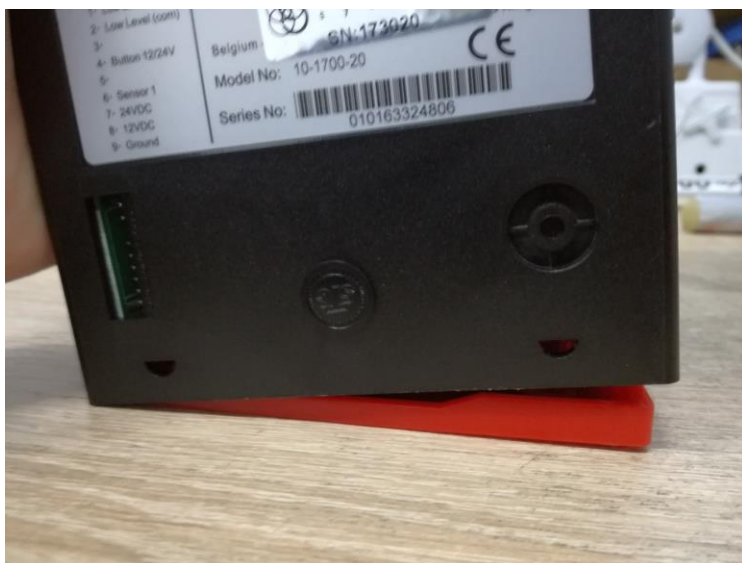
Rys. 1.4. Hopper po zwolnieniu blokady.
